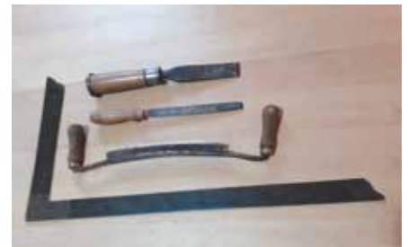
Tesarsko dleto za dolbenje lukenj pri vezavi ostrešja. Rašpla za brušenje lesa. Lajkmesr – orodje za lupljenje lesa. Tesarski vinkl – za označevanje pravokotnih linij.
