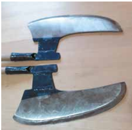
Cimaraki – orodji za tesanje tramov, za levičarje in desničarje.
