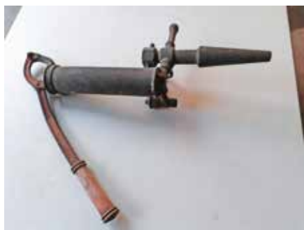
Ročna črpalka za črpanje pijače iz sodov.
