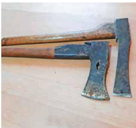
Puntaka – namenjena za izdelovanje lukenj v stebrih pri kozolcu. Večnamenska tesarska sekira.
