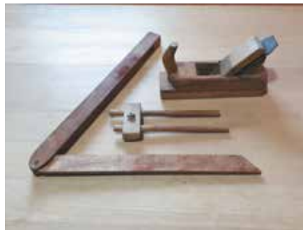
Oblič – za ročno oblanje. Štrajfmus – mizarsko orodje za natančno označevanje spojev pri izdelavi skrinje, omare, pručke itd. Šrekvinkl – za merjenje različnih kotov.
